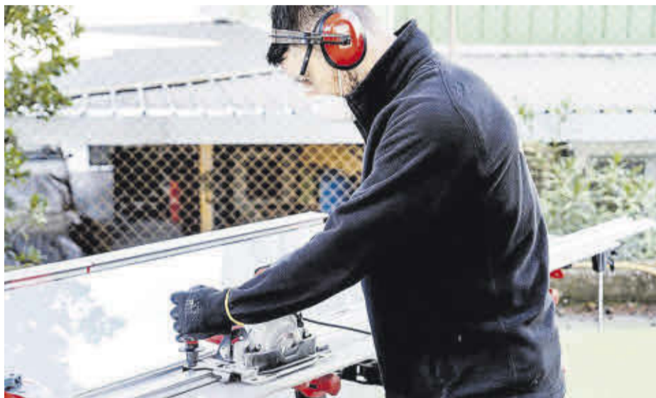
La cortadora circular 'TC-125 G2', una de las novedades para trabajar con placas de gran formato.
